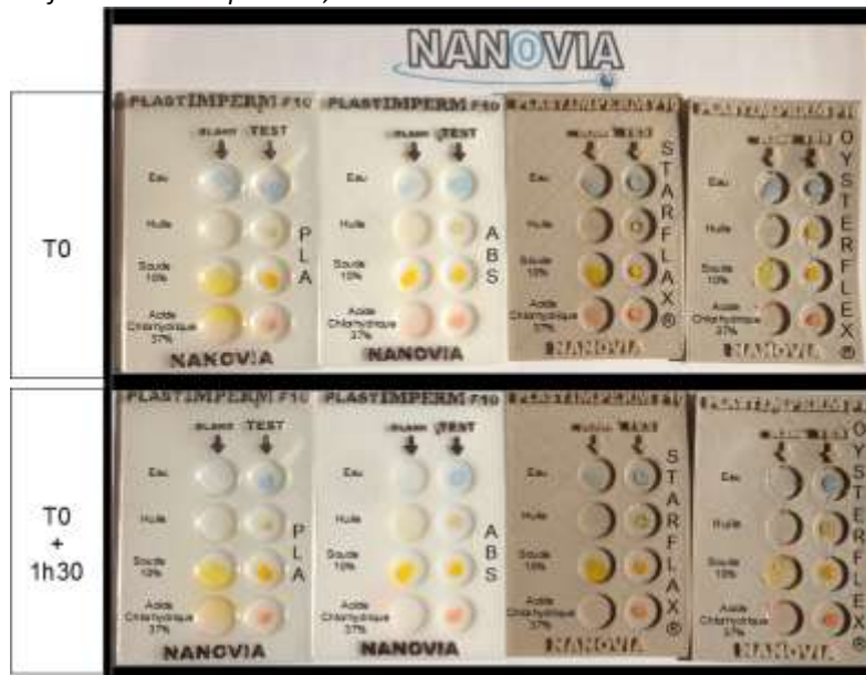
Application de 2 couches de PLASTIMPERM F 10
